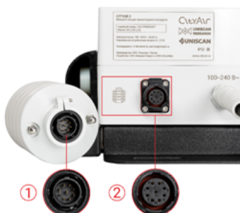
Рисунок 2 – Расположение разъёмов для подключения метеомодуля
